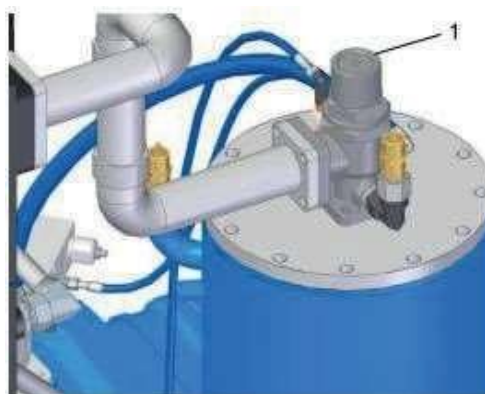
Рис. 10: Клапан минимального давления с функцией обратного клапана
