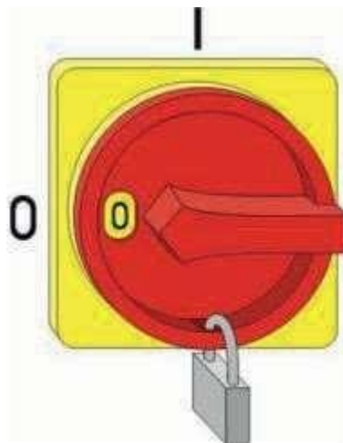
Рис. 22: Фиксация главного выключателя
