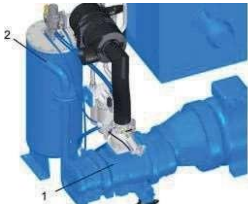
Рис. 7: Винтовой блок компрессора
