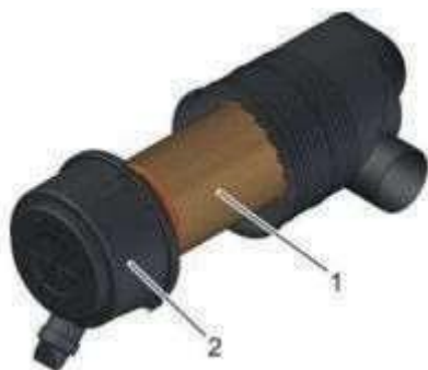
Рис. 42: Разборка корпуса воздушного фильтра
