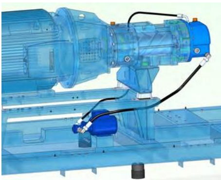
Рис. 16: Насос для смазки редуктора ступени компрессора
