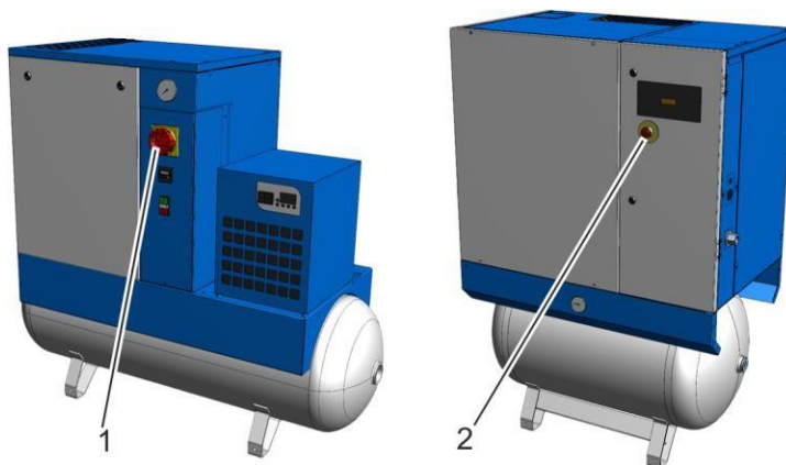
Рис. 1: Расположение предохранительных устройств
