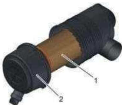
Рис. 42: Разборка корпуса воздушного фильтра
