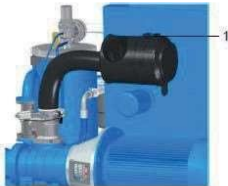
Рис. 41: Расположение воздушного фильтра
