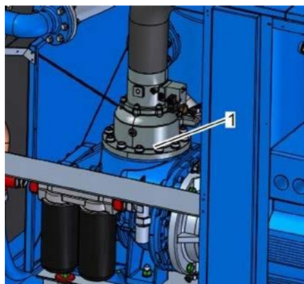
Рис. 32: Крепежные винты регулятора впуска (вариант)
